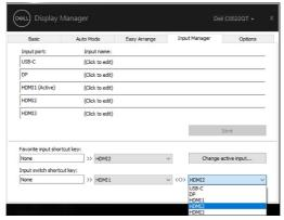
HINWEIS: DDM kommuniziert mit Ihrem Display, selbst wenn der Display Videos von einem anderen Computer anzeigt. Sie können DDM auf dem regelmäßig verwendeten Computer installieren und darüber Eingangswechsel steuern. Sie können DDM auch auf anderen mit dem Display verbundenen Computern installieren.
