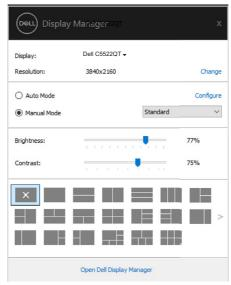
Das Dialogfenster **Schnelleinstellungen** bietet zudem Zugriff auf die erweiterte Nutzerschnittstelle von Dell Display Manager, die der Anpassung grundlegender Funktionen, der Konfiguration des Auto-Modus und dem Zugriff auf weitere Funktionen dient.
