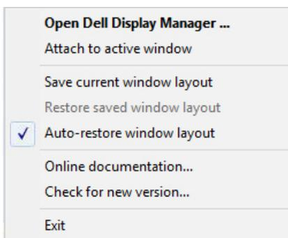
За да се върнете назад към предпочитаното оформление, изберете **Save current window layout (Запис на текущото оформление на прозореца)**, след което **Restore saved window layout (Възстановяване на записано оформление на прозорец)**.
