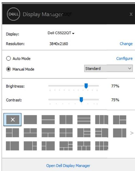
Диалоговият прозорец **Quick Settings (Бързи настройки)** осигурява достъп до разширения потребителски интерфейс на Dell Display Manager, който се използва за настройка на основни функции, конфигуриране на автоматичен режим и достъп до други функции.
