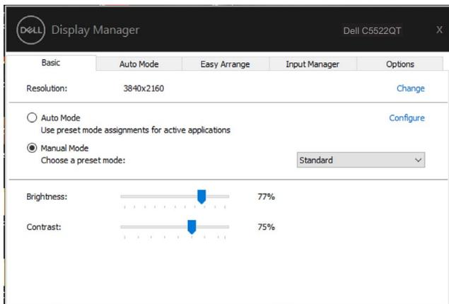
**ЗАБЕЛЕЖКА:** Когато са свързани няколко монитора на Dell, изберете "Enable display matrix control" (Разреша управление на матрицата на дисплея), за да приложите контролите за яркост, контраст и цвят на всички монитори.
