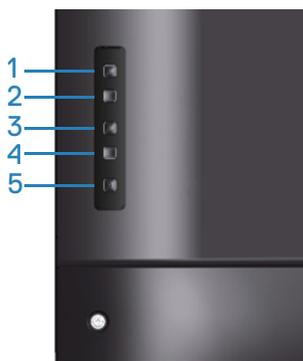
Para entrar no menu de bloqueio do OSD: Segure a tecla Sair (botão 4) por 4 segundos para exibir o menu de bloqueio do OSD (quando o OSD está desbloqueado). Um menu de bloqueio do OSD aparece e é exibido no centro da tela de exibição por 4 segundos.
