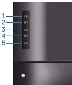
**Ativar Ethernet:** Mantenha pressionada a tecla Para cima (botão 1) por 4 segundos para ativar a Ethernet (quando a Ethernet estiver desativada), um ícone de rede
