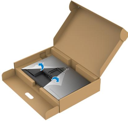
5. Faites glisser les ergots de la colonne dans les fentes du capot arrière de l'écran et appuyez sur le socle pour le mettre en position.
