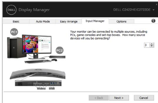
Kod PC1-PC3, izaberite Video Input Port (Port video ulaza) za povezivanje s portom i izaberite USB Upstream Port za povezivanje s portom, a zatim pritisnite NEXT (DALJE).
