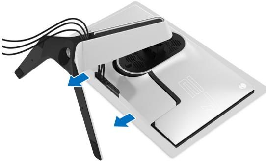
5. 拔除顯示器的連接線，並將連接線滑出可調式支架的連接線整理槽。
