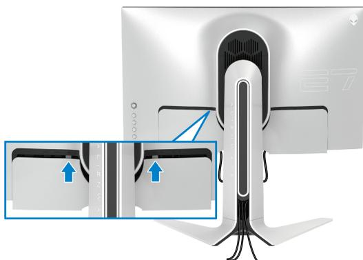
**注意：**確定所有連接線均穿過可調式支架上的 I/O 外蓋和連接線整理槽。
