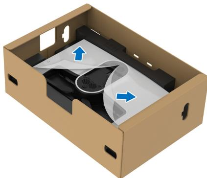
△ 小心：將支架組件連接到顯示器時，請勿將可調式支架直接放在顯示器背面板上。這麼做可能會由於未對準而損壞支架上的彈簧針。
