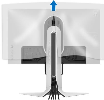
13. 將 I/O 外蓋上的扣件滑入顯示器後蓋上的插槽，直至卡入定位為止。
