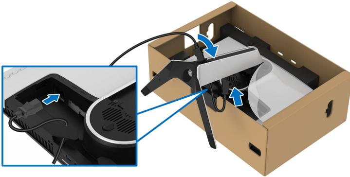
9. 穿過支架的連接線整理槽佈設所需的連接線，例如 USB 3.2 Gen1 (5 Gbps) 上傳連接線、USB 3.2 Gen1 (5 Gbps) 下載連接線、HDMI 連接線和 DisplayPort 連接線。
