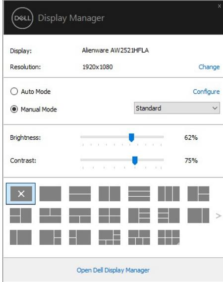
**Hızlı Ayarlar** iletişim kutusu, basic işlevlerin ayarlanması, auto mode'un yapılandırılması ve diğer özelliklere erişim için kullanılan Dell Display Manager'ın gelişmiş kullanıcı arayüzüne erişmenizi de sağlar.
