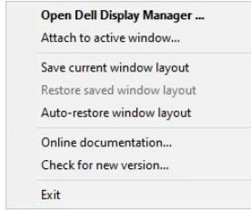
Uygulama pencerelerini taşıdıktan sonra favori düzenine geri dönmek isterseniz, önce **"Save current window layout" (Mevcut pencere düzenini kaydet)** ve daha sonra **"Restore saved window layout" (Kaydedilen pencere düzenini geri yükle)** işlemini yapabilirsiniz.
