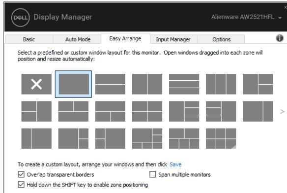
Ako koristite više monitora u nizu ili matrici, raspored **Easy Arrange** (**Jednostavno uređivanje**) može da se primeni na sve monitore kao jedna radna površina. Izaberite „**Span multiple monitors**“ (**Prikazi više monitora**) da biste omogućili ovu funkciju. Morate da pravilno poravnate monitore da biste je načinili efikasnom.
