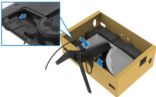
9. Пропустите необходимые кабели, такие как USB-кабель восходящей передачи, USB-кабели нисходящей передачи (эти кабели не входят в комплект поставки и покупаются отдельно), кабель HDMI и кабель DisplayPort через отверстие прокладки кабелей на стойке.
