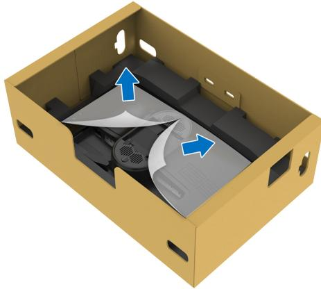
△ **AVVISO: Durante il collegamento del supporto allo schermo, non collocare il supporto regolabile direttamente sul pannello posteriore dello schermo. In questo potrebbero danneggiarsi i perni pogo sul supporto a causa dell'errato allineamento.**
