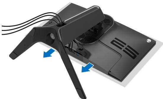
5. Отсоедините кабели от монитора и вытяните их через отверстие укладки кабелей на подъемнике стойки.
