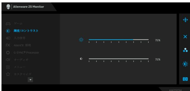
**輝度** 輝度は、バックライトの輝度を調整します。輝度を上げるにはジョイスティックを右に動かします。または、輝度を下げるにはジョイスティックを左に動かします（最小 0 / 最大 100）。
