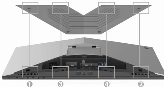
10. En utilisant les pouces et les doigts des deux mains, comme illustré ci-dessous, faites glisser le couvercle des câbles jusqu'à ce qu'il s'enclenche.
