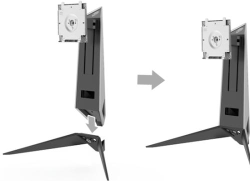
3. Ouvrez la poignée de la vis et tournez la vis dans le sens horaire pour fixer la colonne du pied à la base du pied.
