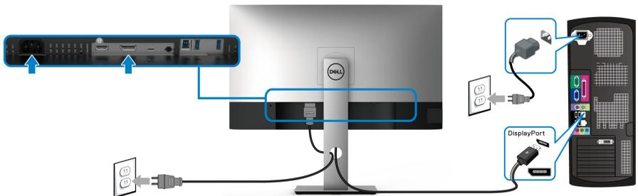
✎ **REMARQUE** : Le réglage d'usine par défaut est DP1.4 (DP1.2 est pris en charge). Si le moniteur ne parvient pas à afficher du contenu après la connexion du câble DisplayPort, suivez les procédures ci-dessous pour modifier les paramètres à DP1.1 :
