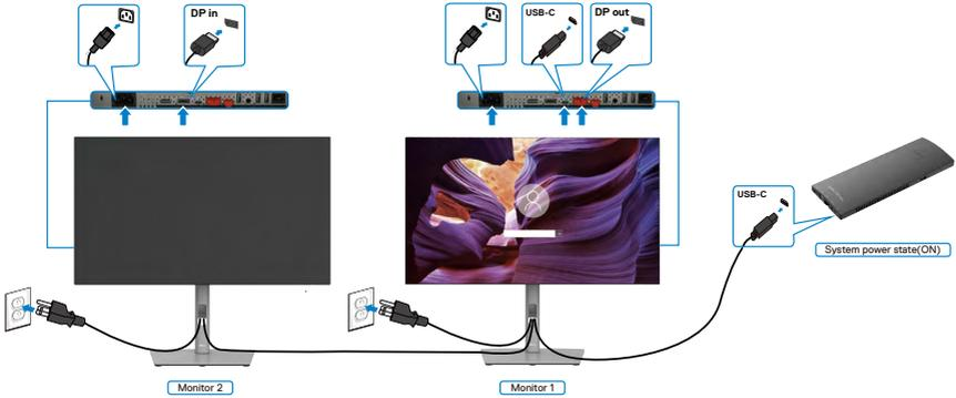
同樣地，電腦在初始開啟電源狀態下連接至兩部顯示器，電腦系統電源狀態與顯示器 1 電源按鈕同步。按顯示器 1 或電腦電源按鈕時，顯示器 1 和電腦都會關閉。同時，顯示器 2 將處於待機模式。必須手動按顯示器 2 上的電源按鈕才能加以關閉。
