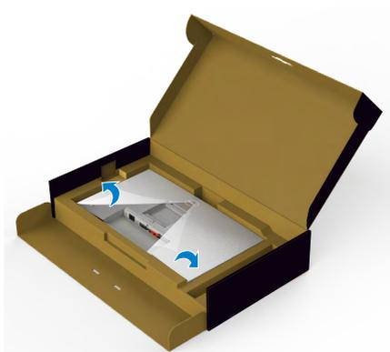
6. 將支架上的卡榫滑入顯示器背蓋上的插槽，將支架總成往下壓以卡入定位。
