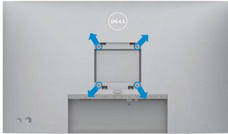
**NOTA:** Use os parafusos M4 x 10 mm para conectar o monitor ao kit de montagem na parede.
