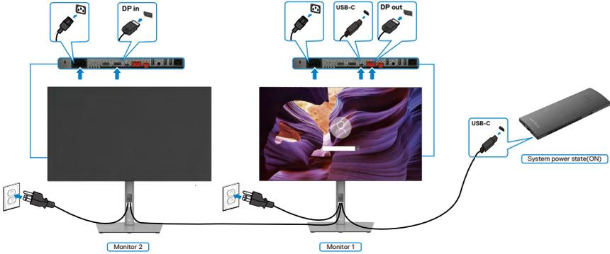
이와 비슷하게 처음 ON(켜기) 전원 상태에서 PC가 두 모니터에 연결되고 PC 시스템 전원 상태가 모니터 1 전원 버튼과 동기화됩니다. 모니터 1 또는 PC 전원 버튼을 누르면 모니터 1 및 PC가 둘 다 꺼집니다. 한편 모니터 2는 Standby(대기) 모드가 됩니다. 모니터 2는 전원 버튼을 수동으로 눌러 꺼야 합니다.
