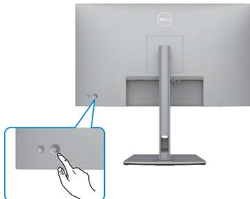
Per modificare le regolazioni OSD utilizzando il controllo del joystick sull'estremità posteriore del monitor, procedere come segue:
