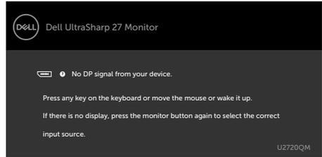
Jika input HDMI, DP, atau USB Tipe C tidak dipilih dan kabel terkait tidak tersambung, maka kotak dialog mengambang seperti ditunjukkan di bawah ini akan muncul di layar.
