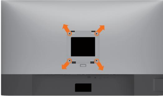
**CATATAN:** Gunakan sekrup M4 x 10 mm untuk memasangkan monitor ke kit dudukan dinding.
