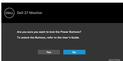
3. Sélectionnez Oui pour verrouiller les boutons. Une fois qu'ils sont verrouillés, l'icône de verrouillage s'affiche lorsque les boutons de commande sont appuyés
