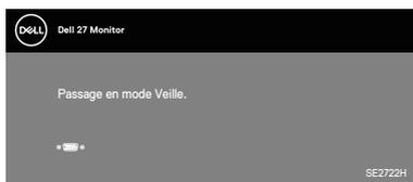
Si le câble VGA ou HDMI n'est pas branché, une boîte de dialogue flottante, indiquée ci-dessous, s'affichera. Le moniteur entrera en Standby Mode (Mode veille) après 4 minutes s'il n'est pas utilisé.
