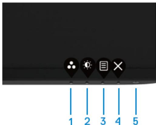
1. Maintenez le bouton 4 enfoncé pendant quatre secondes jusqu'à ce qu'un menu apparaisse sur l'écran.
