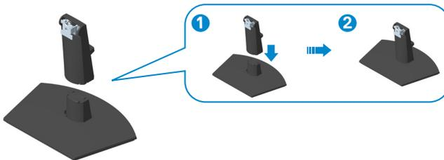
3. Schieben Sie die Riegel an der Ständerbaugruppe in die Schlitze am Monitor und drücken Sie die Ständerbaugruppe zum Einrasten nach unten.
