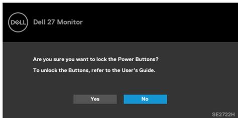
3. Wählen Sie zum Sperren der Tasten Ja. Sobald die Sperre aktiviert ist, wird bei Betätigung einer beliebigen Taste das Schlosssymbol angezeigt
