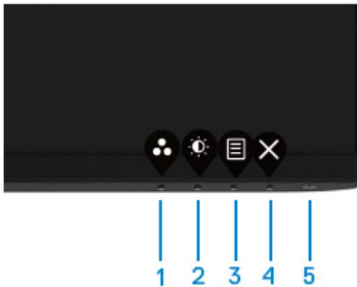
1. Pritisnite i držite Button 4 (Dugme 4) četiri sekunde, nakon čega se na ekranu prikazuje meni.
