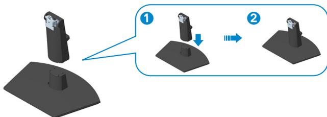
3. Glissez les languettes du support dans les fentes du moniteur et appuyez sur le support pour le fixer.
