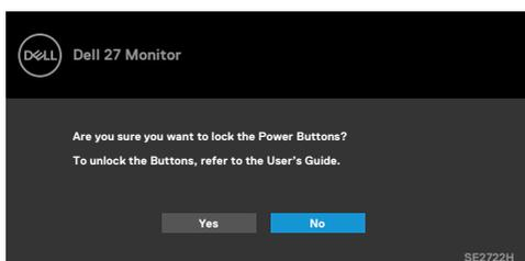
3. Sélectionnez Oui pour verrouiller les boutons. Une fois qu'ils sont verrouillés, l'icône de verrouillage s'affiche lorsque les boutons de commande sont appuyés
