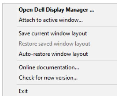
Pokud zvolíte volbu **“Auto-restore window layout (Automaticky obnovit rozvržení okna)”**, DDM bude sledovat a pamatovat si pozice oken vaší aplikace. DDM automaticky vrátí okna aplikace do původních pozic, když připojíte váš počítač k monitoru.
