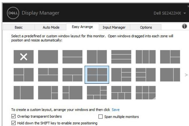
Pokud používáte více monitorů v soustavě nebo matici, uspořádání pomocí funkce **Easy Arrange** lze použít na všechny monitory jako jednu plochu. Zvolte volbu "**Span multiple monitors (Rozložit více monitorů)**" pro zapnutí této funkce. Budete muset monitory řádně spojit, aby byla funkce efektivní.
