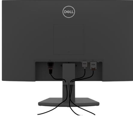
Setelah menyambungkan semua kabel yang diperlukan ke monitor dan komputer, (lihat [Menyambungkan monitor](#) untuk pemasangan kabel), rapikan semua kabel sebagaimana ditunjukkan di atas.
