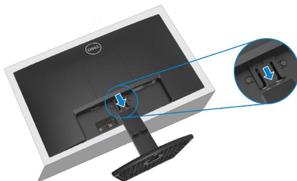
5. Presione hacia abajo el pestillo de la pestaña de liberación rápida en la parte inferior de la base para separar la base del elevador de soporte.
