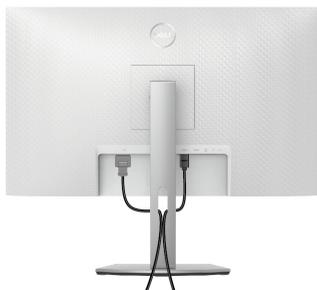
При подключении всех необходимых кабелей (порядок подключения кабелей см. в разделе [Подключение монитора](#)) прокладывайте все кабели так, как показано на рисунке внизу.
