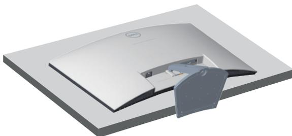
2. ドライバーを使用して、スタンドリリースボタンを押し続け、スタンドアセンブリをディスプレイから取り外します。VEAS用のカバーを押して、カバーを取り外します。
