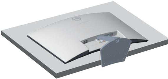
2. Utilice un destornillador para mantener presionado el botón de liberación del soporte y, a continuación, desmonte el ensamblaje del soporte de la pantalla. Presione la cubierta para VESA y, a continuación, desmóntela.
