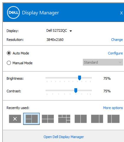
Диалоговое окно **Быстрые настройки** также обеспечивает доступ к дополнительному пользовательскому интерфейсу Dell Display Manager для настройки базовых функций, настройки автоматического режима и использования других функций.
