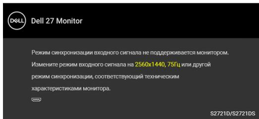
Сообщение означает, что невозможна синхронизация видеосигнала, принятого с компьютера. Диапазоны частот строчной и кадровой разверток, поддерживаемые этим монитором, см. в разделе [Технические характеристики монитора](#). Рекомендуется режим 2560 x 1440.
