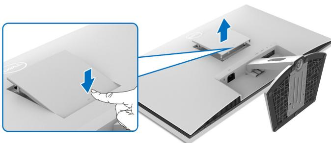
3. С помощью длинной отвертки надавите фиксатор-защелку, расположенную в щели прямо под стойкой.
