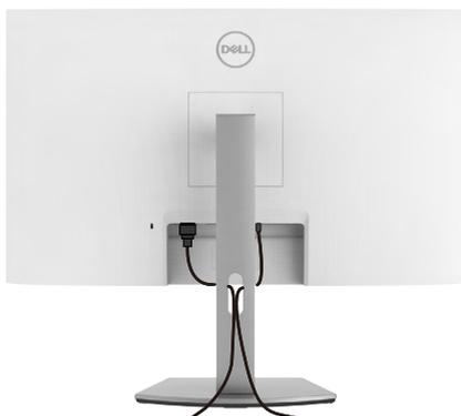
將所有必要纜線連接至顯示器和電腦之後，請如圖所示整理所有纜線。欲深入瞭解纜線連接，請參閱[連接顯示器](#)。
