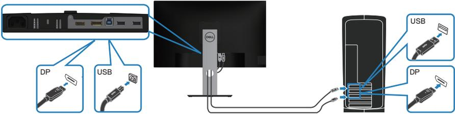
1. 將 USB 上游連接線（顯示器隨附）接至電腦上合適的 USB 3.0 連接埠。
