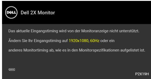
Das bedeutet, dass sich der Monitor nicht richtig auf das Signal einstellen kann, das er vom Computer empfängt. In den [Technische Daten des Monitors](#) finden Sie die von Ihrem Monitor unterstützten Horizontal- und Vertikalfrequenzen. Die empfohlene Auflösung beträgt 1920 x 1080.
