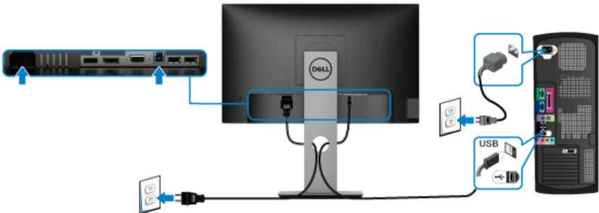
1. Schließen Sie das USB 3.0-Upstream-Kabel (mitgeliefert) an den Upstream-Port des Monitors und an einen passenden USB 3.0-Port Ihres Computers an. (Siehe [Ansicht von unten](#) für Einzelheiten.)
