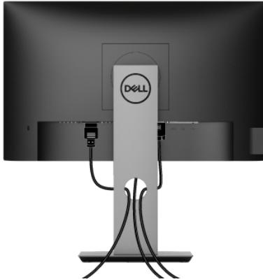
Nachdem Sie sämtliche erforderlichen Kabelverbindungen an Monitor und Computer hergestellt haben (siehe [Monitor anschließen](#)), führen Sie die Kabel wie oben gezeigt ordentlich durch den Kabelschacht.
