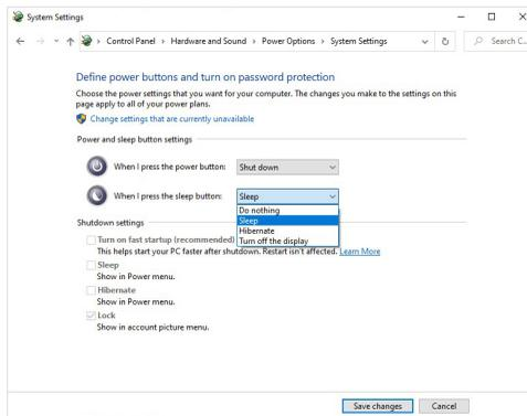
**ПРИМЕЧАНИЕ:** Не выбирайте вариант “Действие не требуется”, иначе кнопка питания монитора не сможет синхронизироваться с состоянием электропитания ПК.
