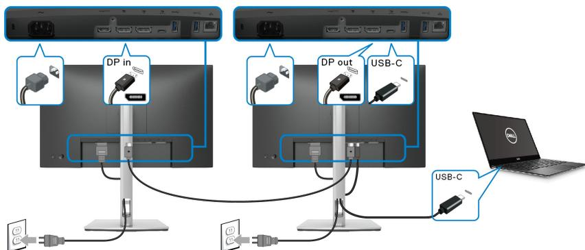
**ПРИМЕЧАНИЕ:** Максимальное количество поддерживаемых мониторов при использовании MST зависит от полосы пропускания источника USB-C.
