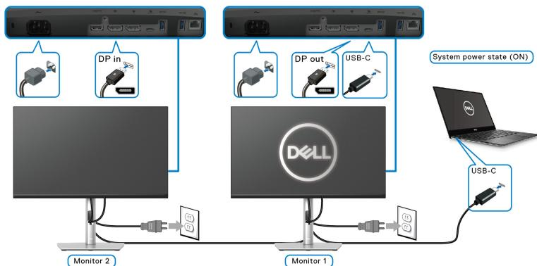
Аналогично, ПК подключен к двум мониторам первоначально с **ВКЛЮЧЕННЫМ** питанием, и состояние питания ПК синхронизировано с кнопкой питания Монитора 1. При нажатии кнопки питания на Мониторе 1 или на ПК **ВЫКЛЮЧАТСЯ** и Монитор 1, и ПК. При этом Монитор 2 останется в режиме ожидания. Чтобы **ВЫКЛЮЧИТЬ** Монитор 2, вам нужно вручную нажать кнопку питания на нем.
