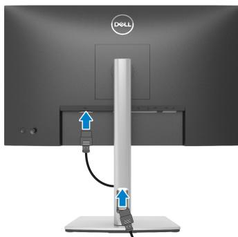
3. Подключите кабель DisplayPort, USB Type-C или HDMI от монитора к компьютеру.
