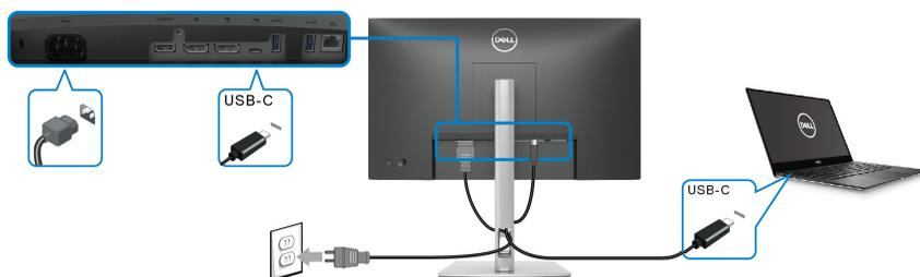
**ПРИМЕЧАНИЕ:** Используйте с монитором только прилагаемый кабель USB Type-C.
