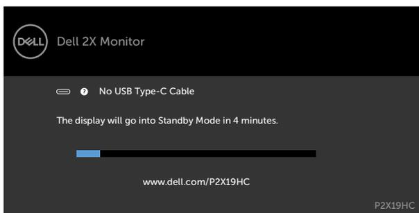
Ako monitor trenutno prikazuje video s DP/HDMI priključka, a korisnik spoji USB-C kabel u prijenosno računalo/telefon koji podržava DP alternativni način rada i ako je odabrana opcija prikaza odzivnika **Automatski odabir za USB-C** za slučaj više unosa, prikazat će se sljedeća poruka:
