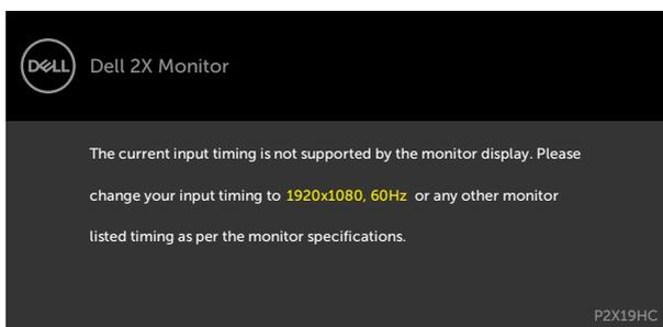
To znači da se monitor ne može sinkronizirati sa signalom koji prima s računala. Pogledajte [Monitor Specifications \(Tehnički podaci monitora\)](#) u vezi raspona horizontalne i vertikalne frekvencije koji se odnose na ovaj monitor. Preporučeni način rada je 1920 x 1080.
