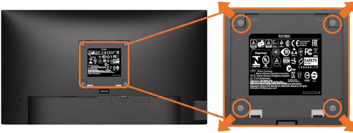
**NAPOMENA:** Koristite M4 x 10 mm vijke za pričvršćivanje monitora na komplet za ugradnju na zid.
