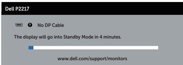
Con **USB** impostato su **On in Standby Mode (Accesso in modalità standby)** per la prima volta, viene visualizzato il seguente messaggio:
