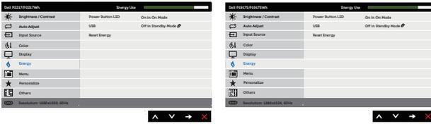
يتيح لك تعيين مؤشر بيان حالة الطاقة على **On In On Mode** (التشغيل في وضع إيقاف التشغيل) أو **Off In On Mode** (إيقاف التشغيل في وضع التشغيل) لتوفير الطاقة.
