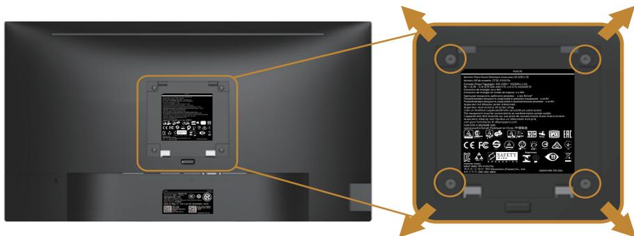
(Dimensões do parafuso: M4 x 10 mm).
