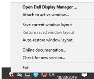
Se você escolher **“Restaurar automaticamente o layout da janela”**, as posições das janelas do seu aplicativo serão rastreadas e lembradas pelo DDM. O DDM coloca automaticamente as janelas do aplicativo em suas posições originais quando você reconecta o PC ao (s) monitor (es).
