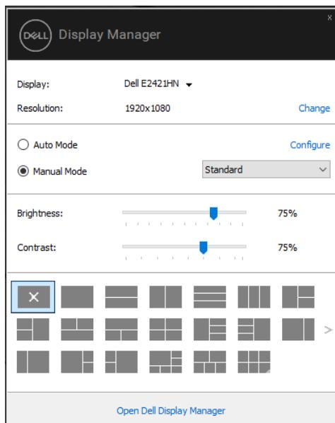
A caixa de diálogo **Quick Settings** também fornece acesso à interface de usuário avançada do Dell Display Manager, que é usada para ajustar funções básicas, configurar o Modo Automático e acessar outros recursos.
