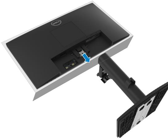
3. Appuyez sur le loquet d'ouverture rapide situé en bas du socle pour séparer la base de l'élevateur du support.
