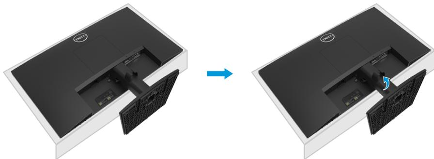
2. a. Utilisez un tournevis long et fin pour enfoncer l'onglet de dégagement situé dans un trou juste au-dessus de la base.
