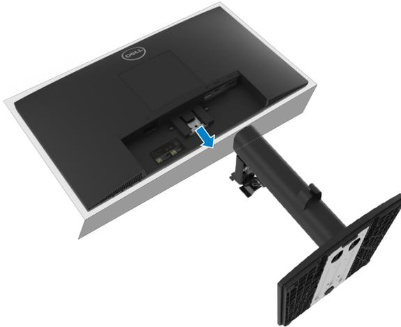
3. 按壓底座底部的快速釋放卡榫門鎖，將底座與立架分開。
