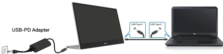
2. Povežite adapter za napajanje Tipa-C za C1422H i povežite C1422H sa mobilnim telefonom pomoću USB kablja Tipa-C.
