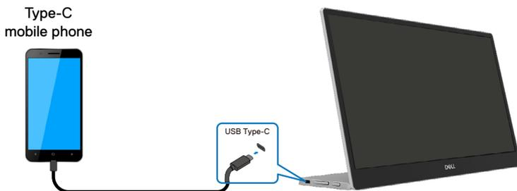
**✍ NAPOMENA:** Za normalno korišćenje, uređaji za laptopove i mobilne telefone koji se povezuju na C1422H treba da podržavaju video signal i izlaz napajanja od 7,5W (5V/1,5A). Kada naiđete na abnormalne uslove prikaza, proverite da vaši uređaji podržavaju USB Tipa-C prikaz u alternativnom režimu i PD2.0 ili noviji. Nakon provere, povežite i pokušajte ponovo.
