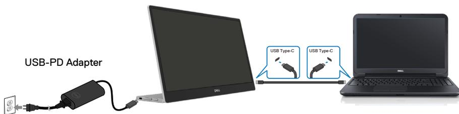
3. Povežite kabl adaptera za napajanje Tipa-C za monitor. Na ovaj način, kompjuter ne utiče na monitor.
