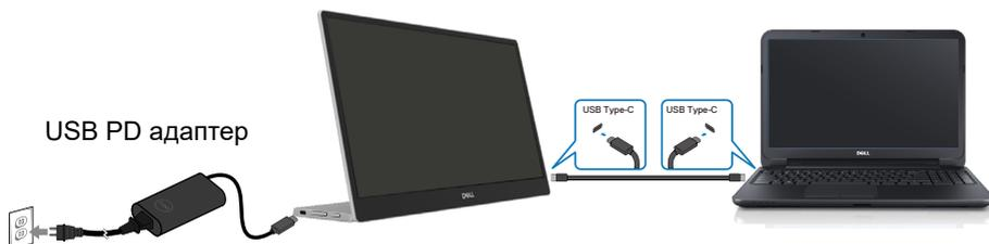
2. Подключите адаптер питания Type-C к C1422H и подключите C1422H к мобильному телефону с помощью кабеля USB Type-C.
