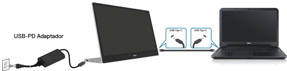
3. Conecte o cabo do adaptador de força Tipo C ao monitor. Deste modo, o computador não deve ser envolvido.
