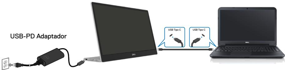
2. Conecte o adaptador de força Tipo C ao C1422H e conecte C1422H ao celular com um cabo USB Tipo C.
