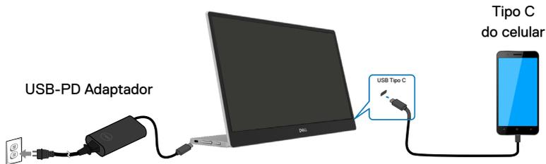
**NOTA:** Quando encontrar uma condição de carga irregular, verifique sua capacidade de força do adaptador de força conectada com C1422H e certifique-se que seja suficiente para o C1422H e outros dispositivos. Para usar o monitor regularmente, consulte [Preset display modes](#) e [Power management](#).
