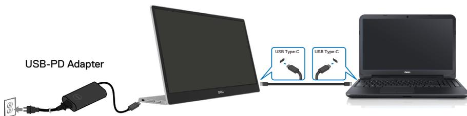
3. Collegare il cavo dell'adattatore di alimentazione tipo C al monitor. In tal modo, il computer non viene coinvolto.
