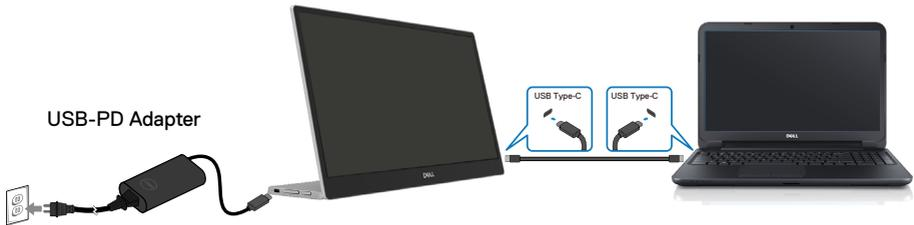
2. Sambungkan adaptor daya Tipe C ke C1422H dan sambungkan C1422H ke ponsel menggunakan kabel USB Tipe C.
