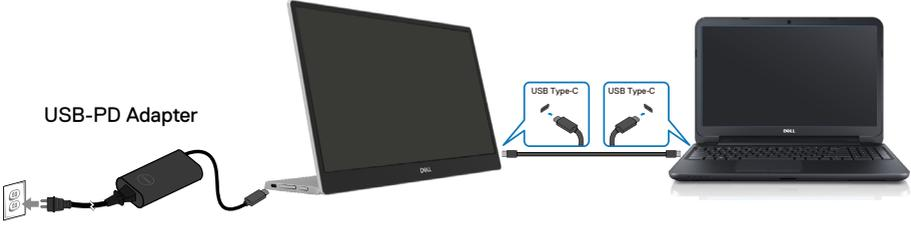
2. قم بتوصيل محول الطاقة من النوع C بالجهاز C١٤٢٢H وقم بتوصيل C١٤٢٢H بالهاتف المحمول باستخدام كبل USB من النوع C.
