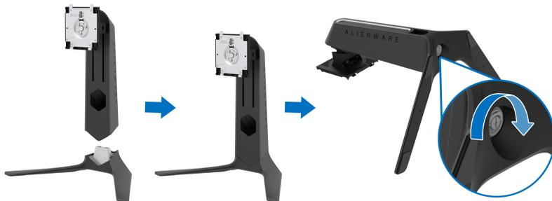
5. Abra a tampa de proteção do monitor para acessar a fenda VESA do monitor.
