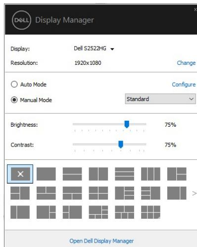
**Hızlı Ayarlar** iletişim kutusu, basic işlevlerin ayarlanması, auto mode'un yapılandırılması ve diğer özelliklere erişim için kullanılan Dell Display Manager'in gelişmiş kullanıcı arayüzüne erişmenizi de sağlar.
